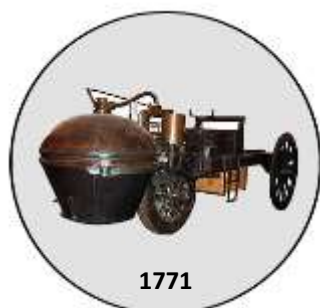
Fardier de Cugnot Premier véhicule automobile (machine à vapeur)
